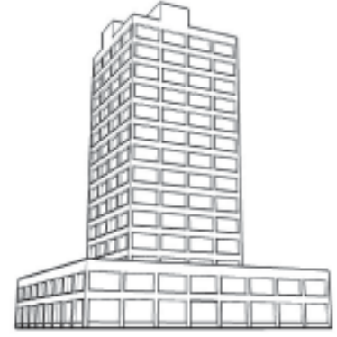
पादक के साथ प्र० क० फ्रेम संरचना R.C. frame structure with Podium टावर Towers
